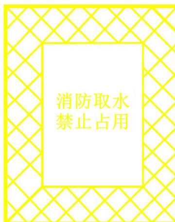
图 B.3 消防取水装置设置场地警示标线
