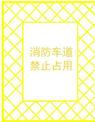
图 B.2 消防车道禁停标线
